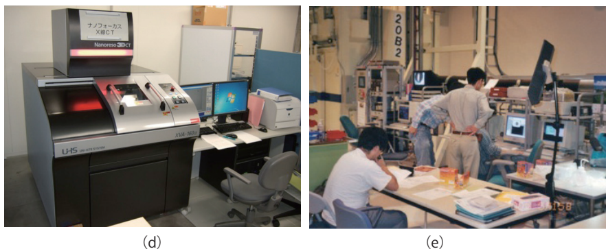
第2図 5種類のCT装置の例。 (a) 東京都立産業技術研究センターにある高エネルギーCT。(b) 産業技術総合研究所にある医療用CT。(c) 東京都立産業技術研究センターにあるマイクロフォーカスCT。(d) 東京都立産業技術研究センターにあるナノフォーカスCT。(e) 高輝度光科学研究センターの大型放射光施設 (SPring-8) にあるシンクロトロンCTのビームライン (背景の白い壁が、周長約 1400 m の蓄積リングの一部)。
