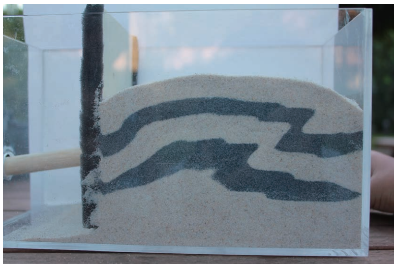
写真1 ミニ断層実験装置と実験により形成された逆断層。 実験容器としてアクリル製の容器を使用。容器中に堆積層を模擬する乾燥珪砂（断層形成時に断層変位が視認しやすい様に水性インクで着色）を設置。容器内にはあらかじめハンドルをつけた「ついたて」を設置。ついたてのハンドルを押したり引いたりすることでついたてを移動させ、堆積層に強制的に変位を与えることで、断層を形成します。
