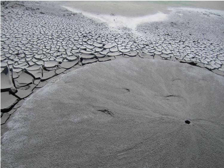
噴砂とその周辺に沈殿した泥（浦安市明海大学テニスコート）.
