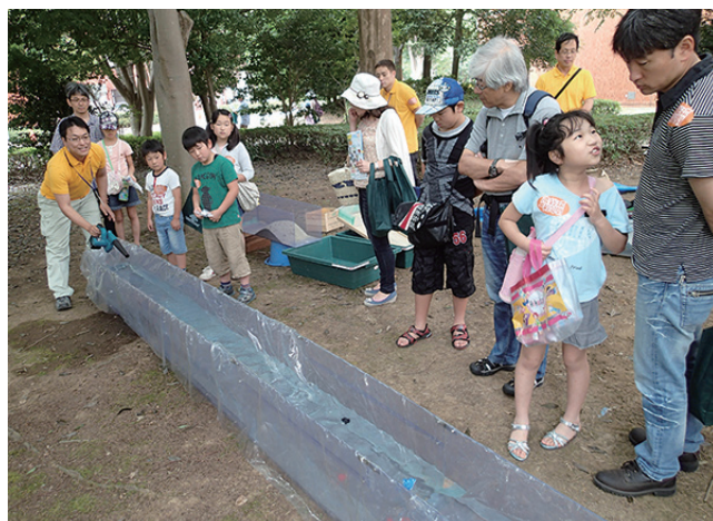
第4図 産総研一般公開ではおなじみとなった津波水槽実験。今年度はコードレスブローアを導入して短周期の風波(暴浪)を生じさせ、長周期の津波との違いを解説した。
