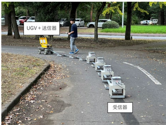
第3図 産総研内での調査の様子。けん引型探査システムを埋設配管に沿って移動させ（2 km/h），地下の比抵抗分布を調べます。
