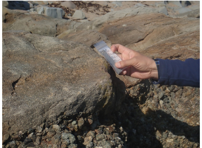
写真2 2日目の野外実習の様子（茨城県ひたちなか市）。（左図）：ルートマップ作成の練習。平らな地面にメジャーをS字状にくねらせて置き、参加者は歩測で距離を測りながらルートマップを描く。（右図）：露頭観察の様子。1日目に作製した粒度表を用いて露頭の粒度判別を行っている。
