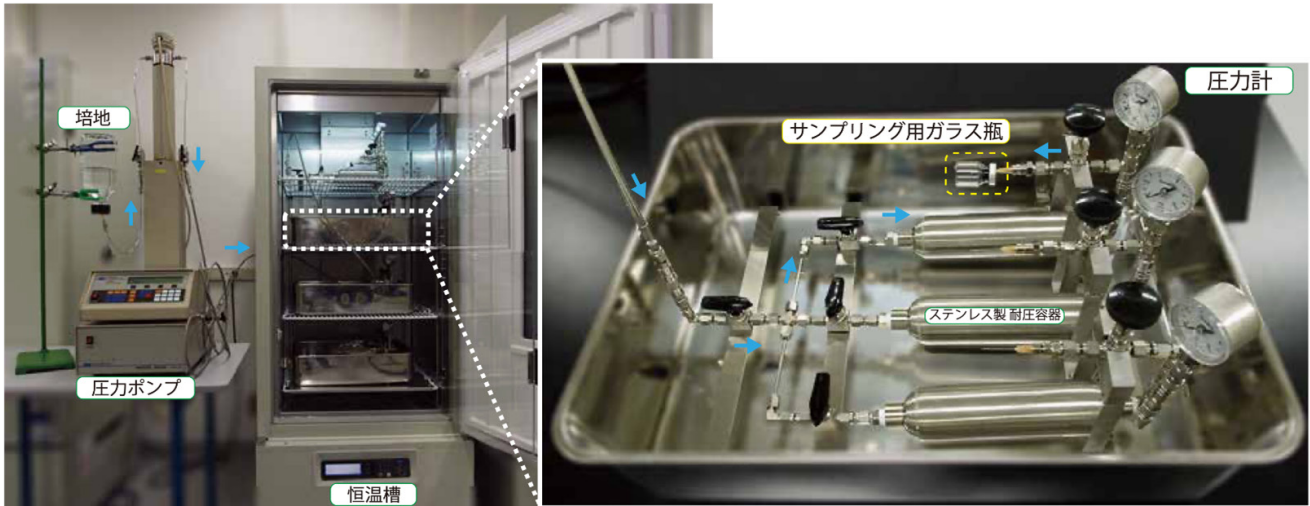
第3図 地下環境を模擬するメタン菌高压培養装置 (Nishikawa system)。(左)装置の全体像(右)培養容器(三連), 培養中も圧力を下げることなく培養液および発生ガスをサンプリング可能。※原論文の図を引用・改変したものを使用しています。
