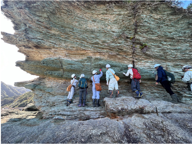
第 10 図 斜交層理を呈する牛切層の流紋岩火砕岩を観察する様子。海風と海水の影響を受けタフォニが見られる。研修 5 日目に猪目湾付近の海岸で撮影。
