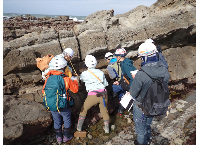
写真 4 柱状図作成実習の様子。ひたちなか市磯崎の海岸露頭で、柱状図作成実習をしているところ。初日に作成した粒度表を砂岩層にあてがって砂岩の粒度を確認したり、砂岩層の堆積構造の観察やメジャーで砂岩層の厚さを計測したりする。第 1 回の研修 2 日目(5 月 14 日)。
