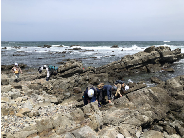
写真2 那珂湊層群の観察の様子 後期白亜紀の那珂湊層群礫層の礫岩・砂岩・泥岩の互層で地層の走向傾斜の測定実習を行っているところ。この後、柱状図作成、地層の上下判定などの実習を行った。 第1回の研修2日目(5月16日;茨城県ひたちなか市磯崎町)。
