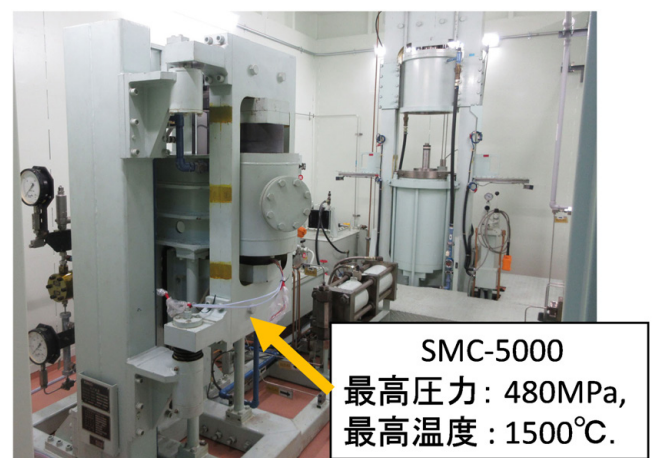
第 1 図 産総研に設置された内熱式ガス圧装置。
