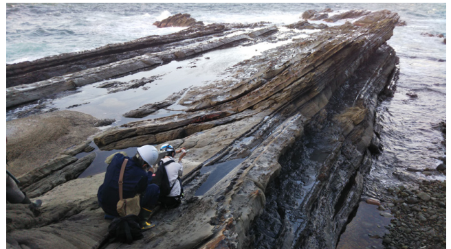
第 4 図 砂岩泥岩互層の走向傾斜の測定実習
