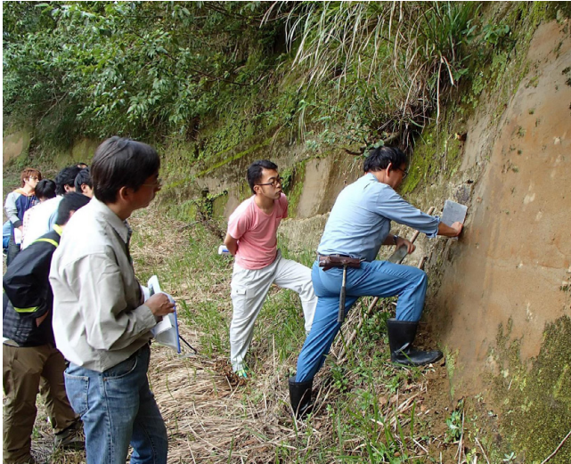
第 30 図 走向板を使った断層面の測定法の実演 (地点 D) 指導しているのは、世話人・案内人の岩本広志氏。詳細は本文参照。2015 年度 (平成 27 年度) 特別見学会 (地質編) (2015.10.20 実施) にて。
