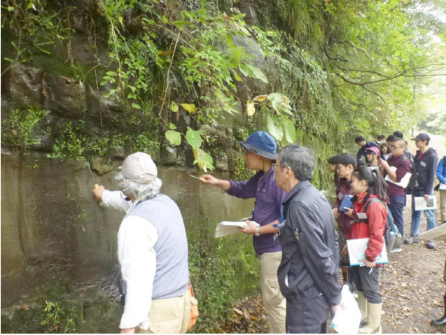
第12図 中瀬遊歩道沿いに露出するタービダイト砂岩層の堆積構造を、ねじりガマで表面のコケを落としながら観察している様子 2018年度(平成30年度)特別見学会(地質編)(2018.11.8実施)にて。
