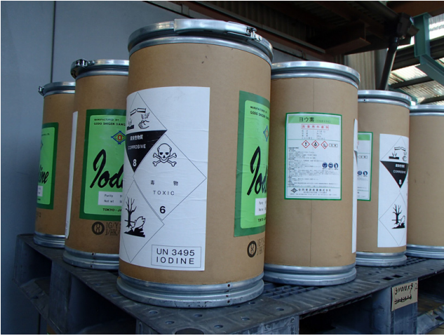
第31図 プリルヨウ素を収蔵して出荷を待つ円筒容器（ファイバードラム） 表面には、出荷元の情報や取扱上の注意を図化したラベルなどが貼られています。
