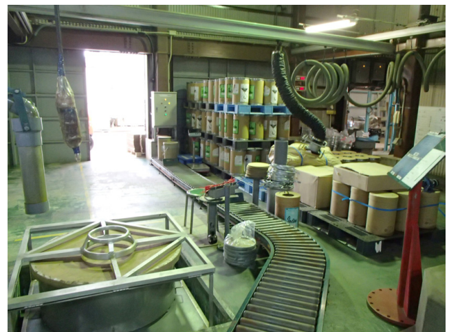
第30図 右奥の円筒状容器にできたばかりのヨウ素を流れ作業的に詰め込む工程の施設 (作業終了済み)
