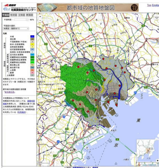
第1図 都市域の地質地盤図 東京都区部。左：トップページ( https://gbank.gsj.jp/urbangeol/ja/map_tokyo/index.html ; 2022年3月4日閲覧)。右：東京都港区田町付近の立体図。水平方向に2.5 km 四方、高さの強調は10倍、ボーリング柱状図の色分けはN値を示している。
