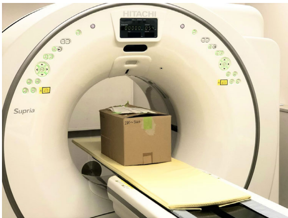
口絵 2 エックス線 CT スキャンによる撮影の様子。非常に脆く壊れやすいため、ビニル袋に詰めた上で段ボール箱に梱包し、撮影を試みた。
