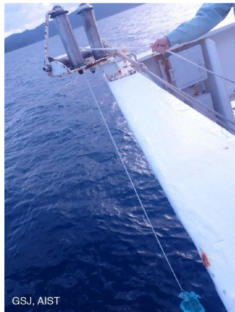
写真10 古仁屋港沖でのプランクトンネットによる試料採取の様子。海面に軽石は見られない。
