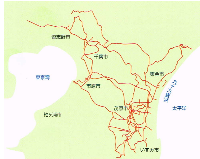
第3図 千葉県内の天然ガスのパイプライン網 天然ガス鉱業会・京葉天然ガス協議会(2019)より引用。
