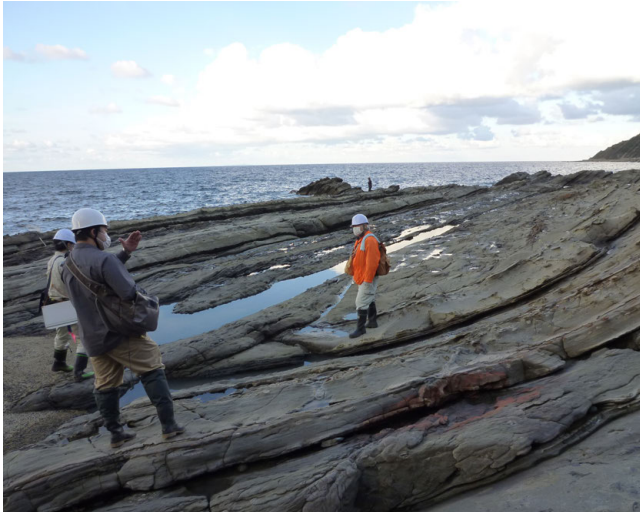
第 6 図 斑れい岩シルの上盤側にある砂岩泥岩互層の観察 研修 2 日目。三津漁港の西方にある海岸で、斑れい岩シルの上盤側の砂岩泥岩互層を観察。ここでは、当時の海底地すべり堆積物（スランプ層）が見られる。砂岩泥岩互層が海岸に露出している場合の走向傾斜の測定の仕方などについても説明した。
