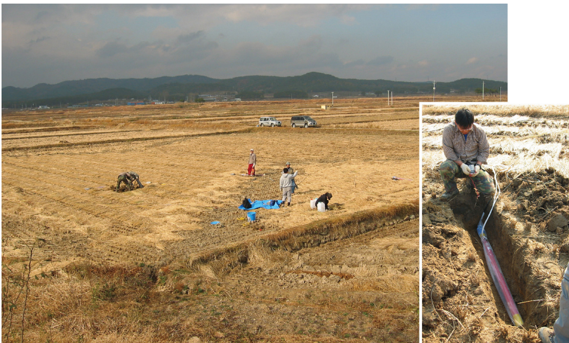
写真4 韓国ポハン地域におけるMT法調査（2002年）。韓国地質資源研究院（KIGAM）との共同研究。GSJの測定装置を持ち込んで技術支援を行い、韓国で初めての本格的なMT法調査となった。
