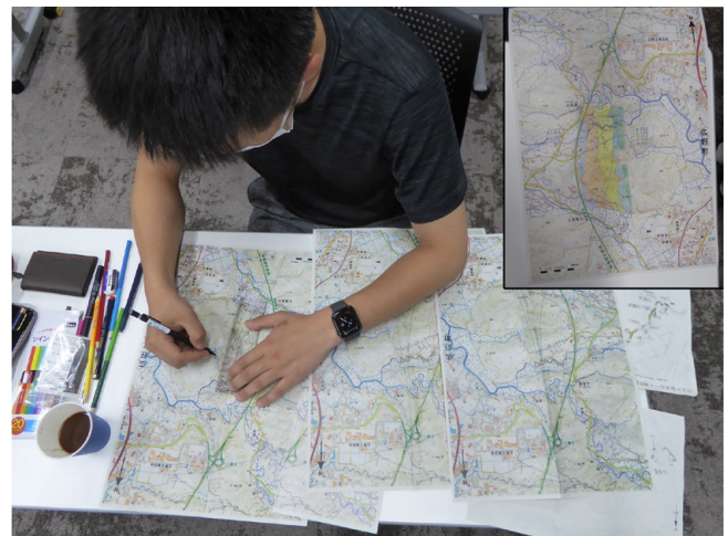
第8図 地質図を作成している様子 ルートマップの調査データを1枚の地図にまとめていき、野稿図を作成する。この研修では時間が限られているので地層境界に関する情報のみを整理して作業した。地質図学を用いて野稿図上に地層境界線を描いていく。最後に、地層ごとの色を決めて凡例を作り、それぞれの地層分布域に着色して地質図を完成させる(右上隅の挿図)。第1回追加の研修4日目(6月2日; 広野町のホテル会議室)。
