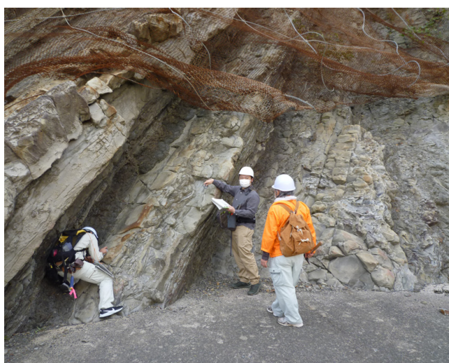
第 3 図 地層の走向傾斜の測定実習
