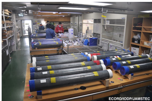
写真7 1 m セクションのコアは実験室に持ち込まれて静置される
