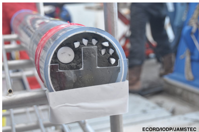
写真6 1 m 毎のセクションの切断面から堆積物試料が採取される。白いのは採取跡の穴を埋めたフォーム、山型のアクリル板は試料採取可能場所を示すための手製のプロテクター。
