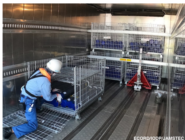
写真9 全てのサンプリングと測定が終わったコアは冷蔵コンテナに収納された
