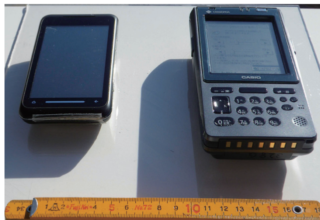
第4図 液晶の比較例。 右の半透過型液晶は、左の透過型液晶よりも直射日光下での視認性に優れるのが分かる。
