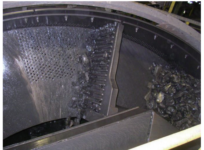
第10図 選炭工場内の選炭過程。 ここで大きさのそろった均質な石炭を選り分ける。
