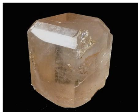
第2図 頂面の発達したトパズ自形結晶。
