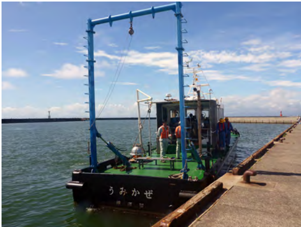
写真1 海底重力調査船。 Photo 1 Survey vessel, Umikaze, 19 tons, 17 m (Yamaguchi Marine Co., Ltd.).
