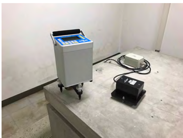
写真4 津第二地方合同庁舎地下室内に設置されている一等重力点 (津GS)。
