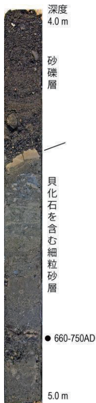
第 8 図 TYMB-7 コア下部の層相と ^{14}\text{C} 年代値 Fig. 8 Sedimentary facies and calibrated ^{14}\text{C} age in the lower part of Core TYMB-7.
