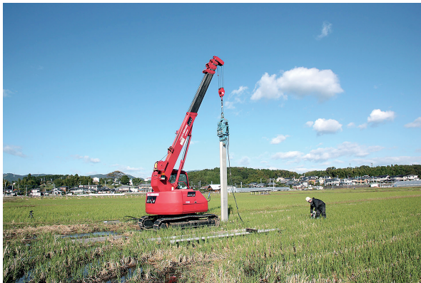
第 3 図 北茨城市におけるジオスライサーの調査風景. Fig.3 Geoslicing in Kitaibaraki City.
