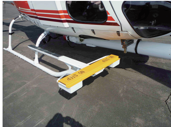
第 5 図 電波高度計（中日本航空（株）所有）。 電波高度計の送受信アンテナ。スキッドのステップ先端部分に取り付けられている。アンテナ間の中央部には対地ビデオカメラの CCD センサーが取り付けられている。 Fig.5 Antennas of a radar altimeter. Owned by Nakanihon Air Service Co., Ltd. The antennas are mounted on the fore tip of a step of the skid of helicopter. A CCD sensor of video camera is installed between the antennas.
