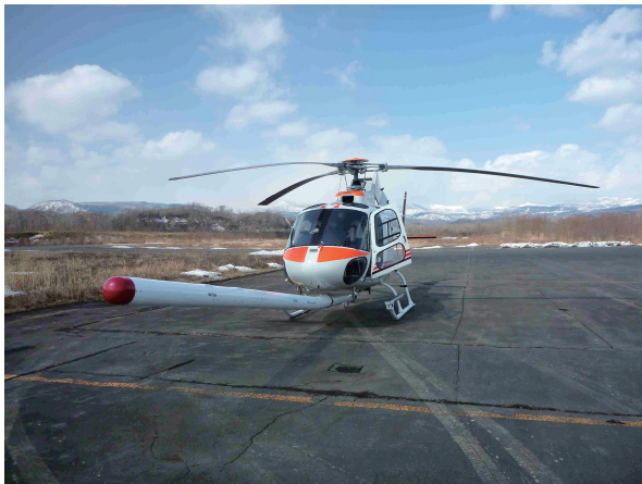
第2図 空中磁気探査調査ヘリコプター（中日本航空（株）所有）AS350B3型機。機体下部にスティンガーを固定し、その内部にCs磁力計センサーおよびプリアンプ、フラックゲート型磁力計センサーを収納する。撮影場所：北海道白老町白老滑空場（以下同様）。
