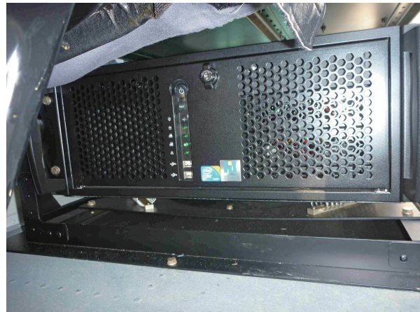
第 7 図 機上データ収録装置（2）。 収録部のラックマウント PC（HPC Systems HPC1000-CD104R4）。MS Windows XP で動作。PCI 規格の A/D 変換ボード PCI-1718HDU-AE（アドバンテック（株））と周波数カウンタボード GT210PCI-8（GuideTech, USA）を内蔵する。 Fig.7 Date acquisition system on board (2). A rack-mounted PC (HPC Systems HPC1000-CD104R4) is operated by MS Windows XP and used for data acquisition on board. Advantech PCI-1718HDU-AE, Universal PCI Multifunction Card and GuideTech GT210PCI-8, Frequency Counter Card is installed inside.
