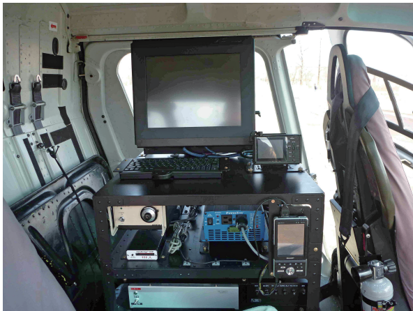
第 6 図 機上データ収録装置（1）。 ラック最上部には、キーボード、15 インチ液晶ディスプレイおよび対地ビデオ収録装置が置かれている。ラック内は三段で、最上段に気圧高度計本体、GPS のデータロガーおよび同操作の PDA が電源と一緒に置かれている。中段にはセンサーカプラーが、最下段には収録部のラックマウント PC が設置されている（第 7 図参照）。 Fig.6 Date acquisition system on board (1). A keyboard, a 15 " LED display and a video deck are mounted on the ceiling of a rack with three shelves. A pressure altimeter, a GPS logger and a PDA as its controller are mounted with a power supply on the top shelf. A sensor coupler is mounted on the middle shelf. A rack-mounted windows PC is mounted on the bottom shelf (see Fig.7).
