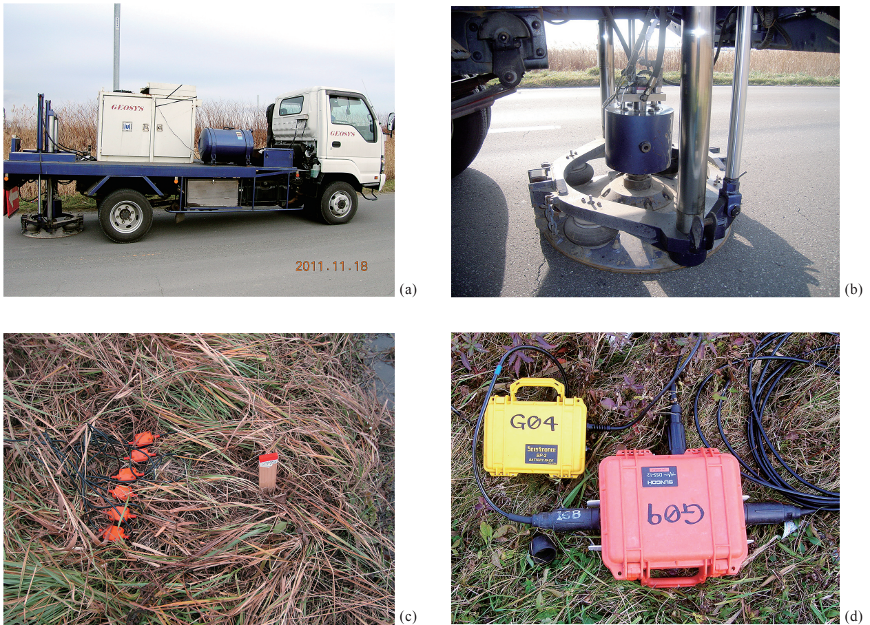
第 5 図 使用機材。(a) ミニバイブレータ (T-15000), (b) 振動部のクローズアップ, (c) 受振器 (SG-10), (d) DSS-12 遠隔記録ユニット (橙色の箱) とバッテリーパック (黄色の箱)。
