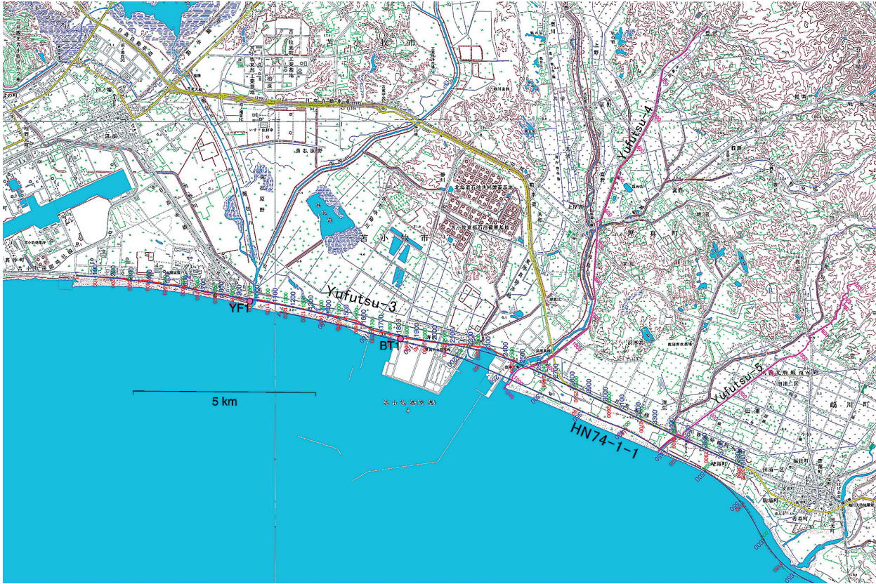
第 3 図 勇払測線 3 および HN74-1-1 西半部の詳細測線図 緑：受振点. 赤：発震点. 青：CMP 重合測線. マゼンタ色の丸印 BT1, YF1 は小松原・小松原（2012）の浅部ボーリング位置を示す. 平成 24 年度実施の測線 4, 5 の受振測線（マゼンタ色の線）も併せ示す. 基図：国土地理院数値地図 50,000 「苫小牧」, 「鶴川」, 「千歳」, 「早来」.
