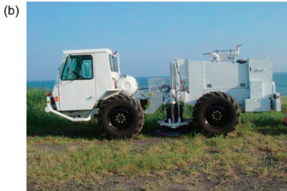
第 3 図 陸域調査機器。 (a) 受振器設置状況, (b) 発震装置 (ENVIRO-VIB)。
