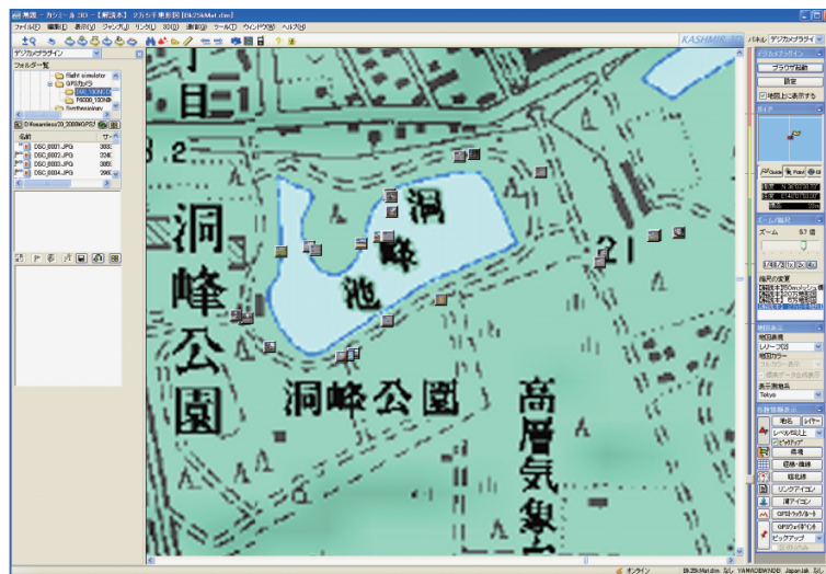
第7図 位置情報と写真情報をリンクさせたもの(四角のポイントが写真撮影地点、フリーソフトウェアのカシミール3D使用)。
