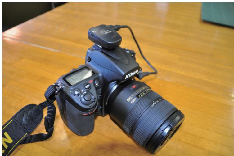
第8図 GPS付きカメラ(頂部にケーブルで接続されているものがGPSユニット)。
