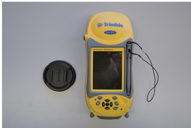
第 2 図 GepExplorer 端末 (アンテナや通信用端末 (携帯電話) と組み合わせて使用する).
