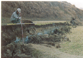
写真79-4 同地区における畦道を直断した地震断層の変位状況 [川崎 満男典氏撮影 (1995.1.18午前)].
