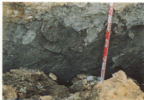
写真79-5 同露頭における断層面の接写、変位傾向を示す条痕が見えるが、約1日経過後ですでに断層粘土脈には乾燥ひび割れが発達し、剥がれかかっている [川崎 満男典氏撮影 (1995.1.18午前)].
