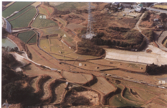
写真84-1 北沢町野島-梨本間の広い谷底における小倉地震断層[アジア航測(株)撮影(1995.1.)].
