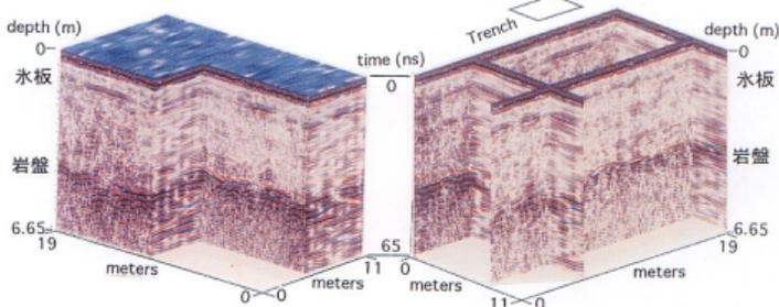
3. 立山室堂平の積雪層で4月に実施したGPR探査の代表的なプロファイル(上图)と3次元表示(下图)。積雪約4mの深度内に複数の反射面が認められる。深度1.2m付近の反射面は連続性が良く、トレンチの結果、同深度に分布する一様な水板の反射面と判明した。また、同範囲のレーダ波速度は0.16m/nsと水の存在を示したが、実際に、融雪水の帯水層となっていることが認められた。
