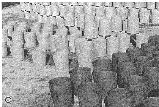
写真1 中国で見た瓦工場 A:瓦葺きの瓦工場,その庭先には焼成を待つ瓦が並べられて乾燥されている。向こうの丘の斜面に登り窯が作られている。B:田んぼから掘り出された粘土は牛に踏ませてよくねりあげる。C:粘土はロクロを使って、底のぬけたバケツのような形に形成され、乾燥される。円筒の四方にミシン目が入れている。D: 登り窯で焼成される。E・F: 焼成された円筒は4つに割られて4枚の瓦となる。この丸瓦を交互に重ねて、屋根が葺かれる。
