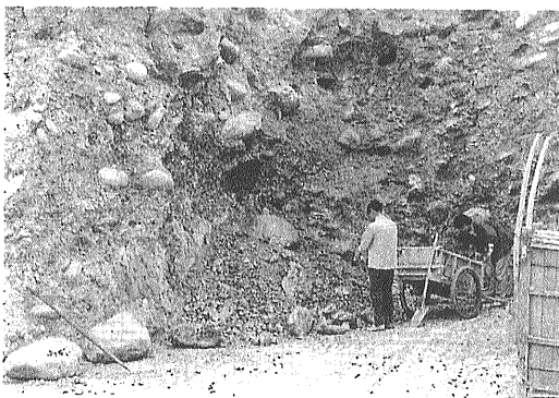
写真4 鉱床をおおひ氷成礫岩。人海戦術で除去される。この厚さが経済性を大きく左右する。
