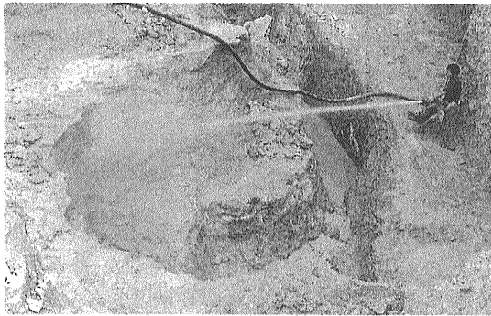
写真5 放水銃によるカオリンの採掘。カオリンを含んだ泥水は水簸場へ流下する。
