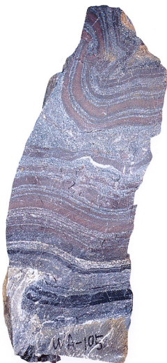
7. カナダ、ワワ地方の縞状鉄鉱石. 下端の炭酸塩鉱物に富む部分から、上へ酸化鉄鉱物、更には黄鉄鉱が富む層に移行する(上下45cm).
