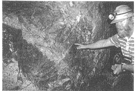
写真7 縞状構造を示すスカルン鉱床, ブラウン・クリーク鉱山.
