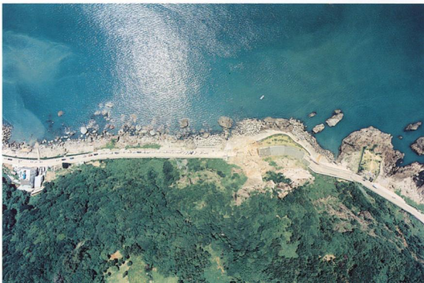
4. 1989年7月16日午後3時20分頃、福井県越前町玉川地先の落石覆工上部の岩盤斜面が高さ25m、最大幅30mにわたって崩落。主に凝灰質角砾岩がほぼ鉛直方向に発達した節理面から剥離、ブロック状にトップリングを起こし、落石覆工30m×2間を直撃した。たまたま通りかかったマイクロバスが遭難し、乗客15名の方全員が死亡。
