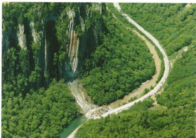
1. 1987年6月9日午前6時15分頃、北海道上川郡層雲峠の天城岩が比高145m、幅20mにわたって崩落。柱状節理構造の層雲峠培結凝灰岩がその節理面から剥離、ほぼ鉛直の急崖斜面を滑落。崩落岩塊は崖下の樹木を根こそぎ取り、石狩川を瞬時に横断し、100m以上も離れた国道39号線に達し、通行中の車両を直撃した。3名が死亡しサイクリング途中の6名が重軽傷を負った。
