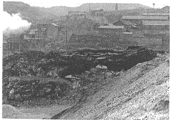
写真4 錫鉱山の旧坑。地層面にほぼ平行な鉾脈の跡が空洞になって残っている。
