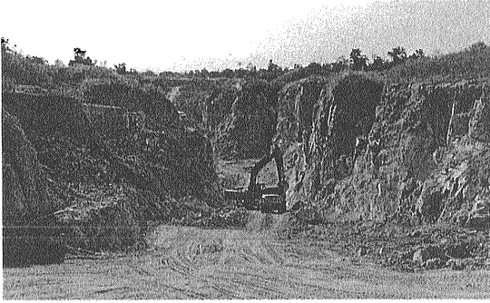
写真4 長石採掘場の全景(タク市東郊外)。鉱床が割れ目に沿った脈状鉱床なので、平原の中に巨大な直線状の溝が掘られることになる。
