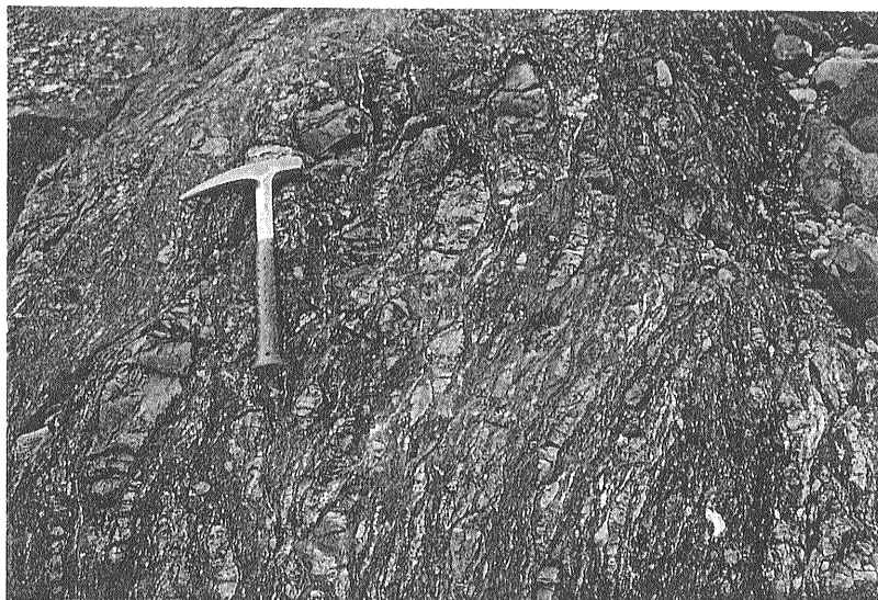
写真2 メランジュ(地質図オーダー)の基質の露頭写真(第4図の小津川沿い)。砂岩とチャートのブロックが泥質基質に含まれる。地質図オーダーと同様に露頭オーダーでも基質にブロックが含まれる構造が顕著である。
