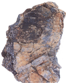
6. 自然着鉛 (Native bismuth) : Bi 栃木県上都賀郡足尾町尾尾鉱山 チャート中の石英脈中に石英の空隙を充たして劈開 の著しい結晶の集合をなす。(GSJ M 12324) × 1
