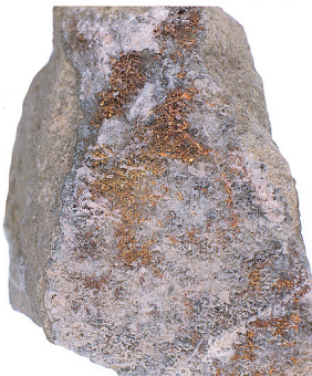
2. 自然金 (Native gold) : Au 鹿児島県薩摩郡薩摩町山ヶ野鉱山 浅熱水性金銀鉱床の石英の細脈中に苔状又は薄い紐 状の集合をなす, (GSJ M 12529) × 1.5
