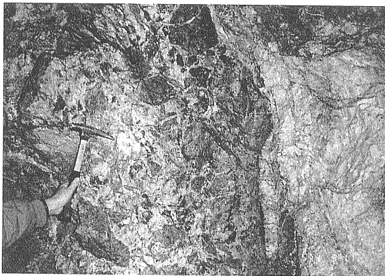
写真15 Lunny 第9 鉱体の鉱脈。最大幅 4 m, 角礫は母岩の変質安山岩。
