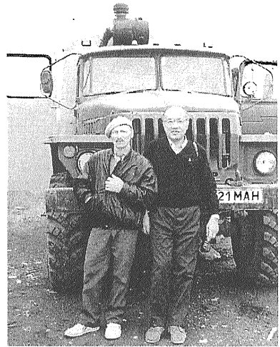
写真6 巡検用に使用した水中でも使える四輪駆動バス。高さと運転席直上の排気塔(水中走行用)に注目。
