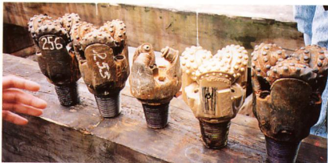
6.コアリング用の大口径ダイヤモンドビットと得られたコア。(写真:斎藤清次)
