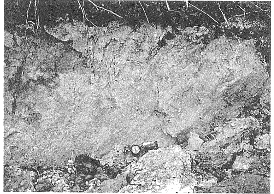
写真3 断層面上に見られる条線(1月23日)。
