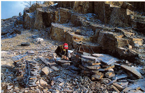
1. 板石山頂での鉄平石加工風景（1994年3月）。小さな削岩機様の道具で節理面にすじを付け、裏からたたくと棒状の石材ができる。
