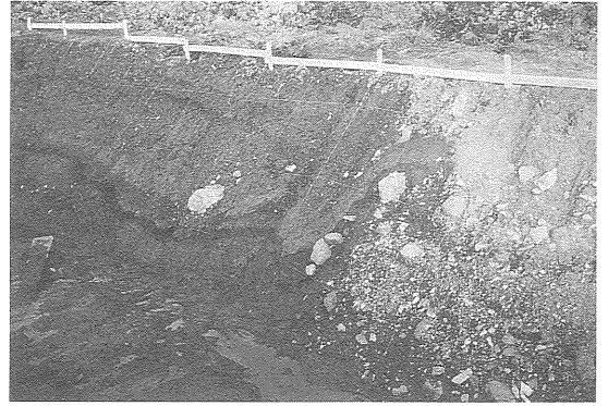
写真4 トレンチ東側壁面 写真中央の断層帯で下部の腐植層が地溝状に変形し、そこに断層崖から崩れ落ちたとみられる礫が挟まれている。
