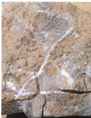
10. Neves-Corvo鉱床のCu-Sn鉱石は、黒色頁岩か緑泥石化した火山岩類に伴う縞状鉱(写真9)を主とするが、一部に珪質な高品位Sn鉱石(最大20%Sn)も産する。主に細粒の石英と錫石からなり、黄銅鉱を含む石英脈に切られている。
