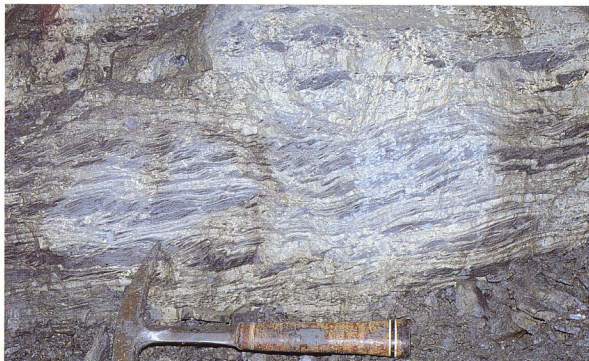
9. ポルトガルのNeves-Corvo鉱床は、Cuに富むだけでなく多量のSnを含む点でもIPBでは特異な鉱床である。確定鉱量1.5億トン(2-17%Cu)以上。うち3千百万トンは平均Cu品位8%、Sn鉱石は3百万トン(平均2.5%Sn)が確認されている。写真の暗色縞に錫石が濃集、黄色は黄銅鉱。
