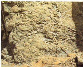
3. San Dionisio層状鉱体下盤の網状鉄脈鉱体。写真は風化面で、黄鉄鉱と黄銅鉱を含む石英脈が突出。母岩は変質した酸性火山岩、中央にハンマー。
