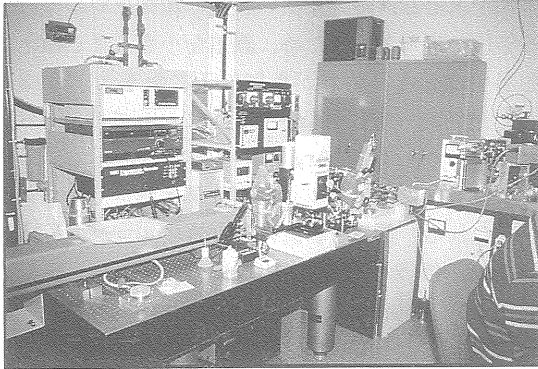
写真1 極微量 ^{40}\text{Ar} - ^{39}\text{Ar} 年代測定のためのレーザー試料融解精製装置(アメリカ合衆国地質調査所メノパーク支所)。台の上の横長の筒がアルゴン連続レーザー発振装置。その右側に赤外温度測定センサー付きの顕微鏡および CCD カメラ付きの双眼顕微鏡装置が並んでいる。レーザー発振装置の後ろ側のラックに、赤外温度測定装置、画像収録用ビデオ、レーザーコントローラーが収まっている。写真右端が、超高感度アルゴン専用質量分析計の試料導入部。
