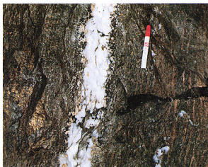
5. 鉍石の累帯配列. 鉍石は一般に, 石英脈を中心に両側へ, 高品位鉍石(灰重石に富む白雲母-緑泥石-斜長石-石英岩) → 比較的低品位のざくろ石-単斜輝石スカルン → 珪灰石スカルン (1-3cm) → 石英岩という累帯配列を示す. 写真は鉍化の弱い所で, 石英脈に近接してざくろ石-単斜輝石スカルンが産する, 右側の赤褐色の縞はざくろ石濃集部, 左の黄色は黄銅鉍, 同様の累帯配列が藤ヶ谷鉍床でも明瞭に観察される (Sato,1980).
