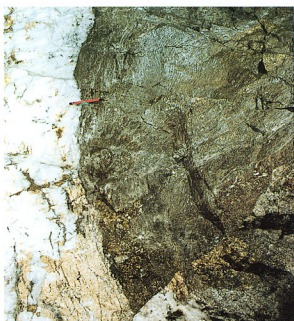
4. 高品位縞状鉍と石英脈中の塊状灰重石, 左: 通常光 (中央下の黄色は黄銅鉍), 右: 紫外線.
