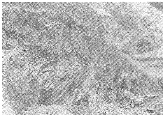
写真5 玄昌石の原石採掘現場。もちろん登米層粘板岩(雄勝町明神, 雄勝天然スレートKK)。層理面は写真の左側に60度傾斜している。
